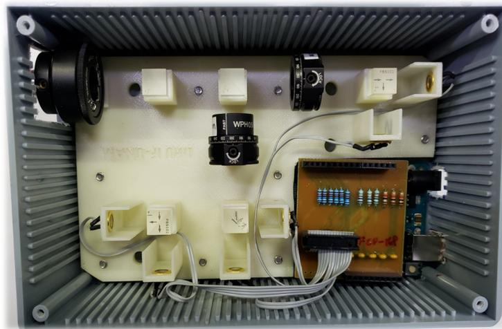
Figura 6.13: Fotografía del analizador de polarización actualmente utilizado en el LMU.
