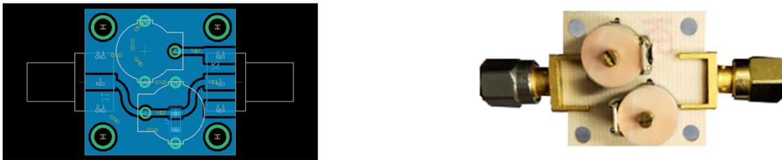
Figura 4.5: Circuito de acoplamiento de impedancias (sección en L). Izquierda: Esquemático. Derecha: Circuito construido.
